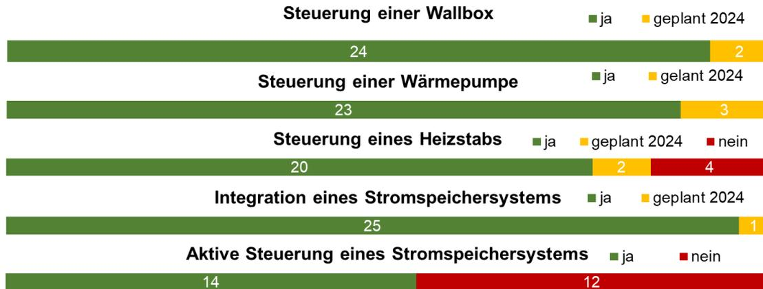
**Abbildung 7** Übersicht der gerätespezifischen Integration von flexiblen Verbrauchseinrichtungen im HEMS.
